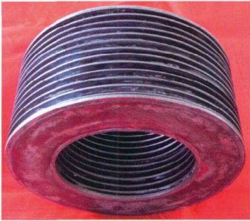
图7 叠形波纹管结构样件
